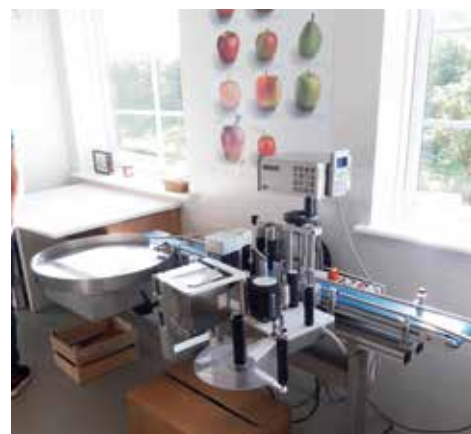
6: Etikettiermaschine. Bild: Rolf Lühs
